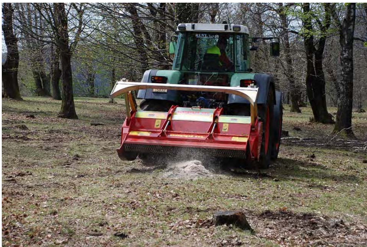
Foto n° 3: Trinciatrice SEPPi della ditta Agromeccanica (scheda tecnica allegato 1)
