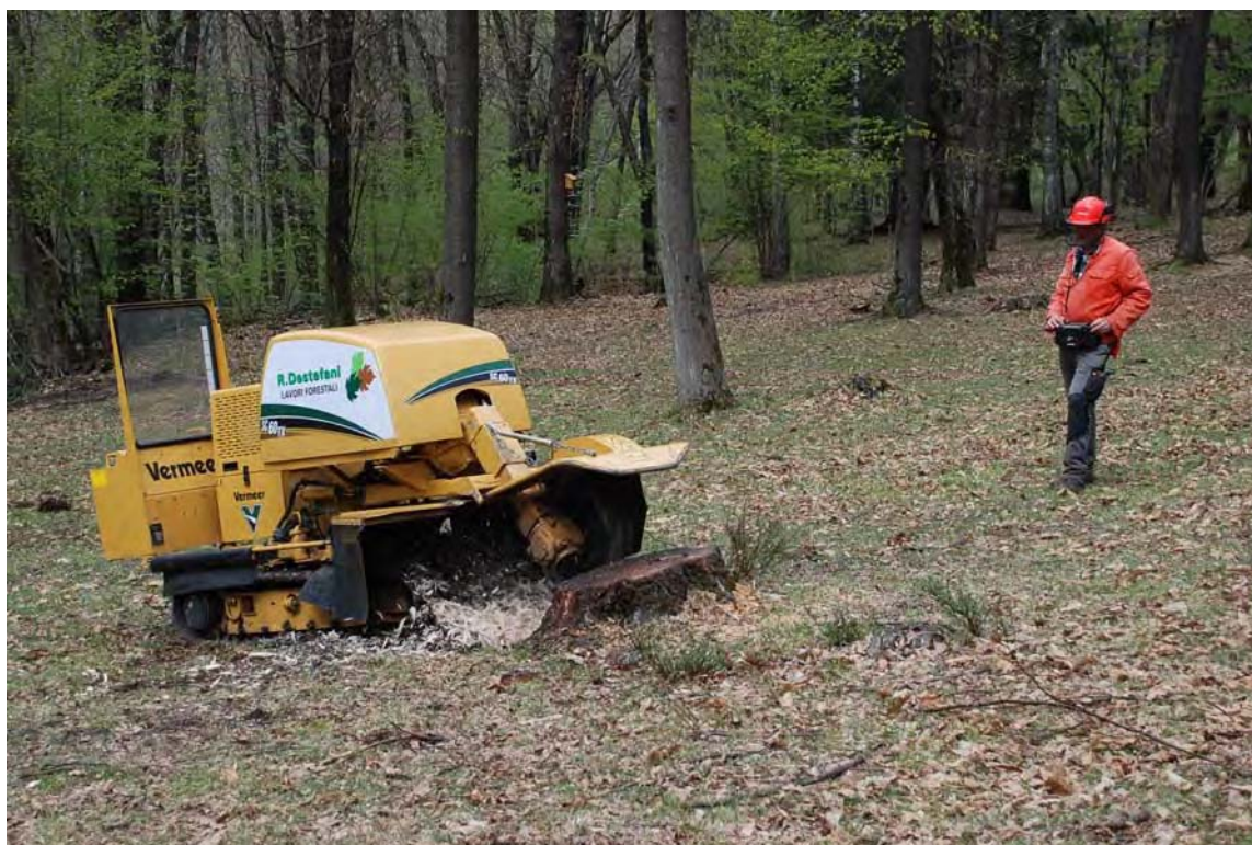
Foto n° 1: Fresaceppi Vermeer della ditta DeStefani (scheda tecnica all'allegato 1)
