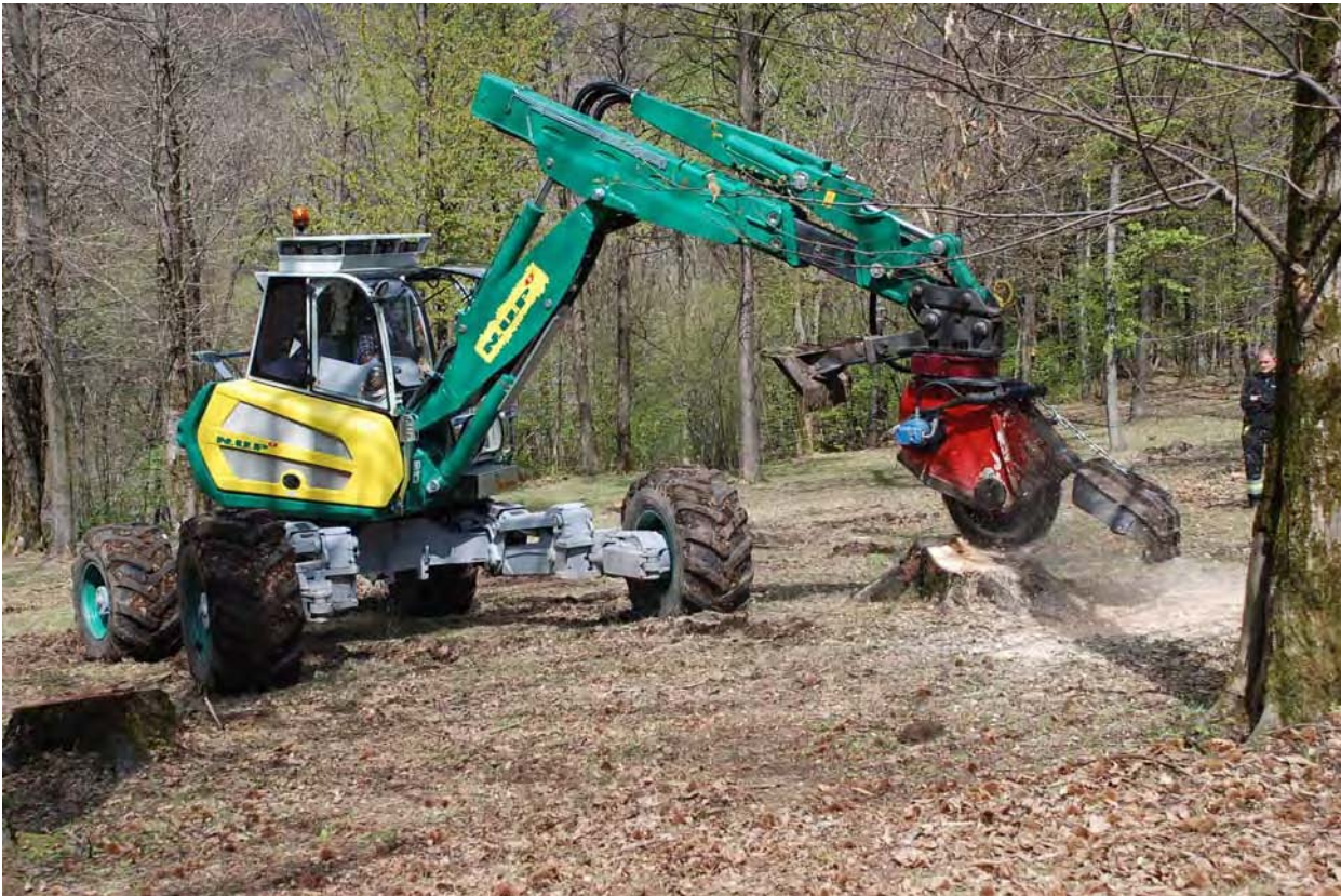
Foto n° 2: Braccio fresante attaccato ad un menzi muck della ditta NUP (scheda tecnica allegato 1)
